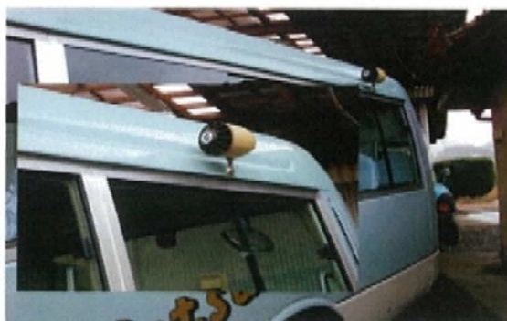
車外情報提供設備(車外スピーカー)
