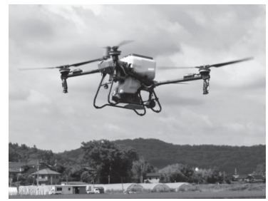
肥料を散布中の大型ドローン
