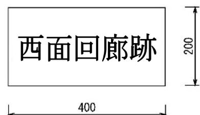
図 5-27 名称表示板（埋込型）の整備例（参考図）
