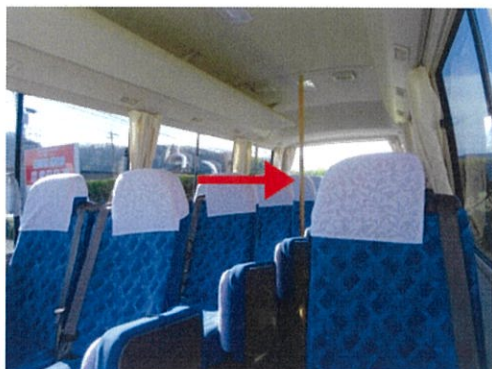
車内補助棒設置
