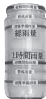
簡易雨量計 (身近なもので簡単に作製できます)
