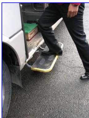
三次市民バス吉舎町線で運行している 車両に導入された補助ステップ
